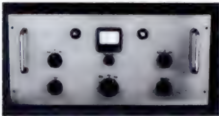
Bild 1. Auf der Frontseite des als Einschub aufgebauten Speisegerätes sind die Bedienungsorgane übersichtlich angeordnet
