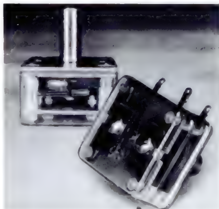
Bild 1. Zweifach-Drehkondensator für Transistorgeräte; vorn Aufsicht auf die Trimmerseite, dahinter Seitenansicht
